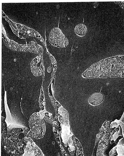
写真3 アロイ化物の破断面
