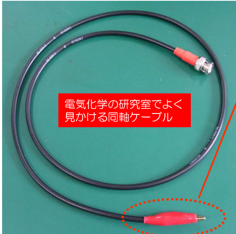
とある同軸ケーブルの例 (BNCオス - ワニ口クリップ X1 )
