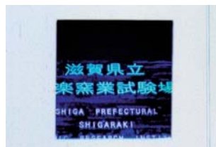
門柱銘板 Name Plate using U.V. Emitting Glaze
