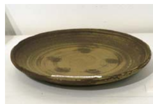
バイオリアクター担体 Porous Ceramic Bioreactor 中空樹脂粉末を利用した多孔質軽量陶器 平成7年(1995年) 滋賀県立信楽窯業試験場 日本国特許登録番号 3273310
