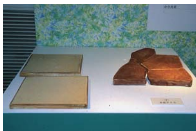
歩道タイル 上写真の赤い歩道の部分と、奥にある白いデッキの床面タイルです。素材は、大型軽量プランターと同じで、焼成収縮を抑えた素地です。
