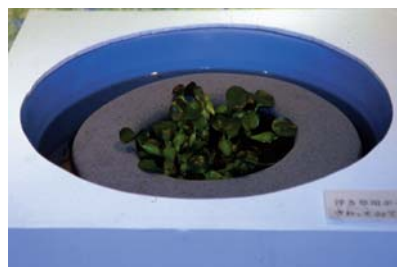
浮き草用ポーター SiC などによって発泡させた軽量素地は、閉じた気孔を持つ構造となり吸水性がありません。比重が水より小さく、水に浮く植木鉢も製作可能になります。
