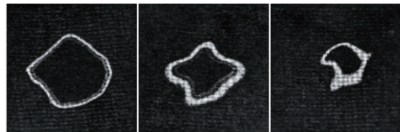
CFRPの落下衝撃試験後の超音波探傷結果 (左から、エポキシ樹脂、ウルテム、S-63)
