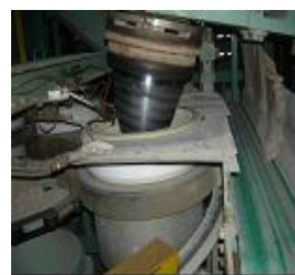
写真 ローラーマシンによる成形と脱型
