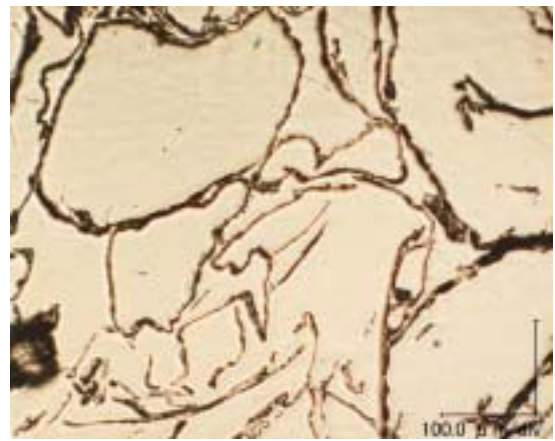
図 5 粗粉末焼結体の組織写真
