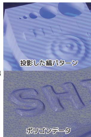
図1 三角測量の原理と縞パターン
