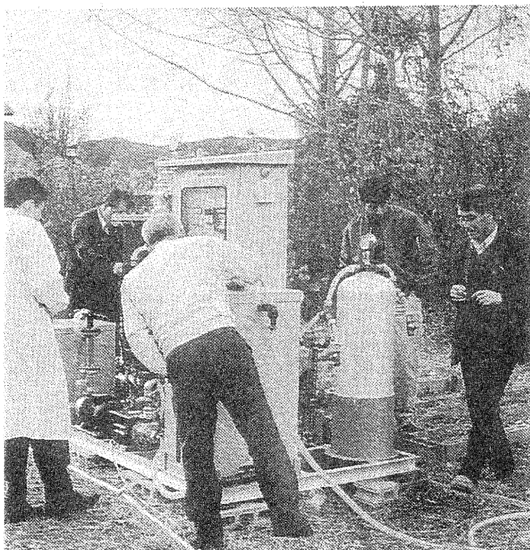
大津市の滋賀大教育学部でリン除去回収装置の運転実験をする川嶋教授（右端）ら（県産業支援プラザ提供）
