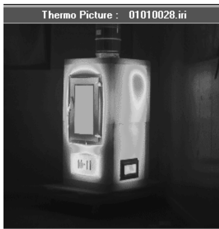
図10 陶板を外装とする薪ストーブの赤外線画像
