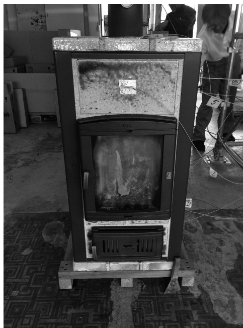
図9 陶板を外装とする薪ストーブ 高さ95cm
