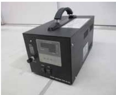
陶磁器の焼成時において炉内の酸素濃度を測定する装置です。酸素濃度を測定できるだけでなく、還元焼成時は還元を程度のマイナスの酸素濃度として測定できるため、酸化・還元どちらの焼成雰囲気管理にも使用できます。
