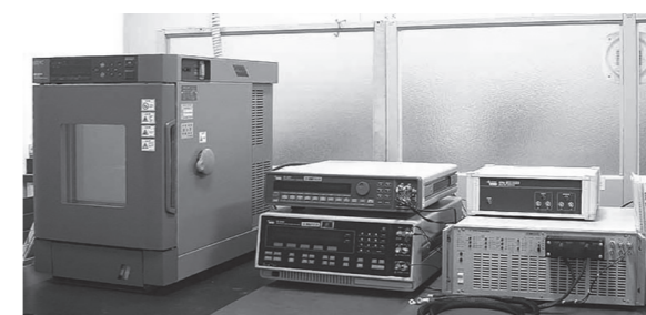
電気化学測定装置、インピーダンスアナライザ (Solartron / 1287,1296,1260 株式会社東陽テクニカ / PBI250-10,SH1-Z エスペック株式会社 / SH-24)
