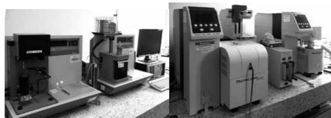
図1 当センターに設置している熱分析装置 (左：TA Instruments製 右：リガク製)
